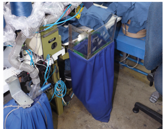
Una de las ventajas que ofrece la manufactura esbelta es que fomenta la implementación de ideas para la mejora continua. Arriba un operario de GILDAN diseñó una barrera de acrílico para evitar que los desperdicios de hilos caigan al suelo manteniendo limpia su área de trabajo.
